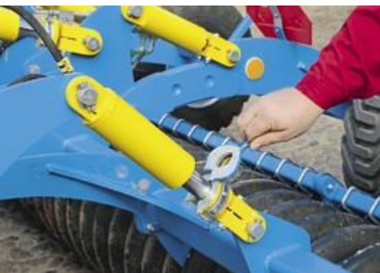
Gute Clips begrenzen den Weg der Hubstange. An allen Zylindern gibt es Parkmöglichkeiten für die Clips. Gut gefallen hat uns der informative Aufkleber über Farbkombinationen und Arbeitstiefen.
