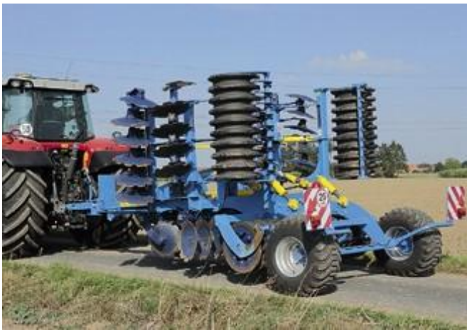
Das Außenmaß der Beleuchtung betrug bei der Testmaschine über drei Meter. Das lag laut Farmet an der falsch montierten Tafel.
