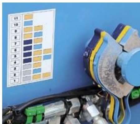
Gute Clips begrenzen den Weg der Hubstange. An allen Zylindern gibt es Parkmöglichkeiten für die Clips. Gut gefallen hat uns der informative Aufkleber über Farbkombinationen und Arbeitstiefen.
