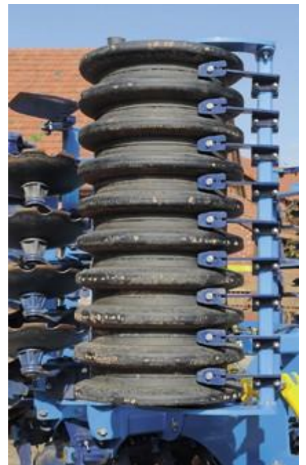
Die Gummiringwalze hat gute Arbeit geleistet. Einzeln nachstellbare Abstreifer halten die Walze sauber.
