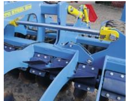
Angeschweißte „Spritzschutze“ schützen die Kolbenstange vor aufgeschleudertem Boden und Steinen. Das ist gut, mit der sich ablagernde Erde kann man leben.
