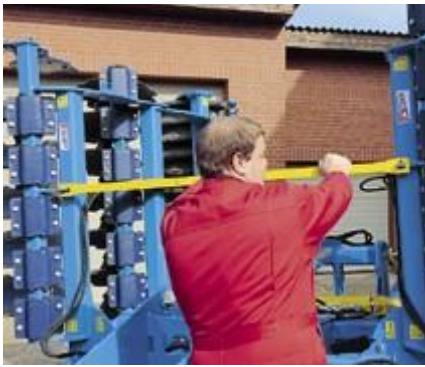
Zur Straßenfahrt muss eine Sicherung aus Flachstahl angebracht werden. Das ist zwar sehr sicher, aber auch aufwändig.
